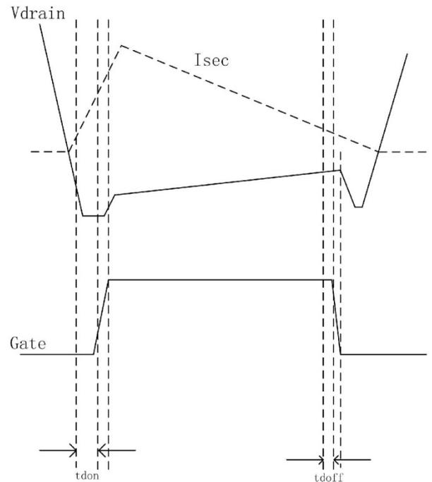
图 1 SR 管开启及关断时序
